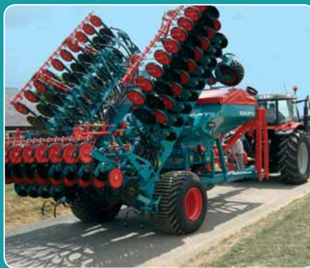
RW – diskový SOLO výsev s přitlakem na výsevní disk do 80 kg, bez přípravy, 6 m, 8 m, 9 m hydraulicky sklopná na 3 m
