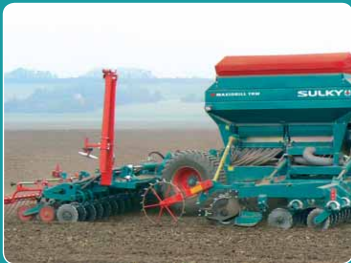
MAXIDRILL TRW : příprava půdy / utužení / setí, 6 m hydraulicky sklopná na 3 m
