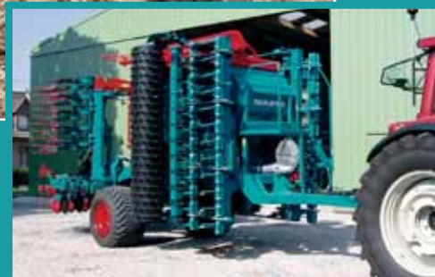
Ось безопасного транспорта (заstopоренная), сверхширокие шины 700/40R22.5
